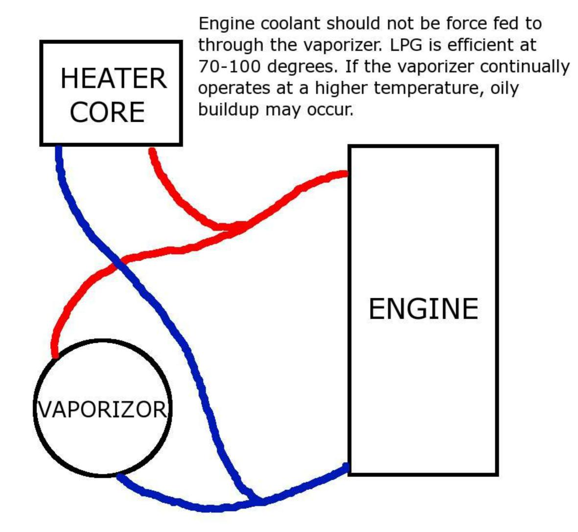
COOLANT CONFIGURATION FOR VAPORIZER
